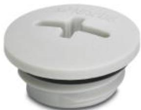
Verschlusschraube, Material Verschraubung: PA, Anschlussgewinde: M16 x 1,5, Farbe: lichtgrau RAL 7035, mit O-Ring
