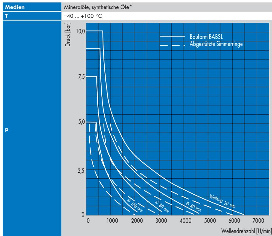
Zulässiger Druck im Aggregat für Simmerringe (Baiform BABSL), sowie für abgestützte Simmerringe.
