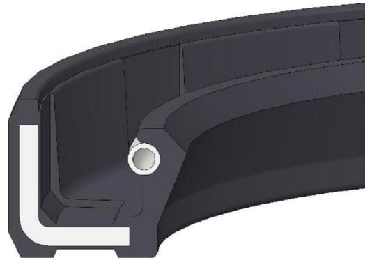
Radial-Wellendichtring in der Standardausführung in Anlehnung an die DIN 3760 mit einem elastomeren Außenmantel und einem metallischen Versteifungsring sowie einer federunterstützten Dichtlippe. Zusätzlich ist die Standardausführung mit einer Schutzlippe (WAS) zur Bodenseite erhältlich.
