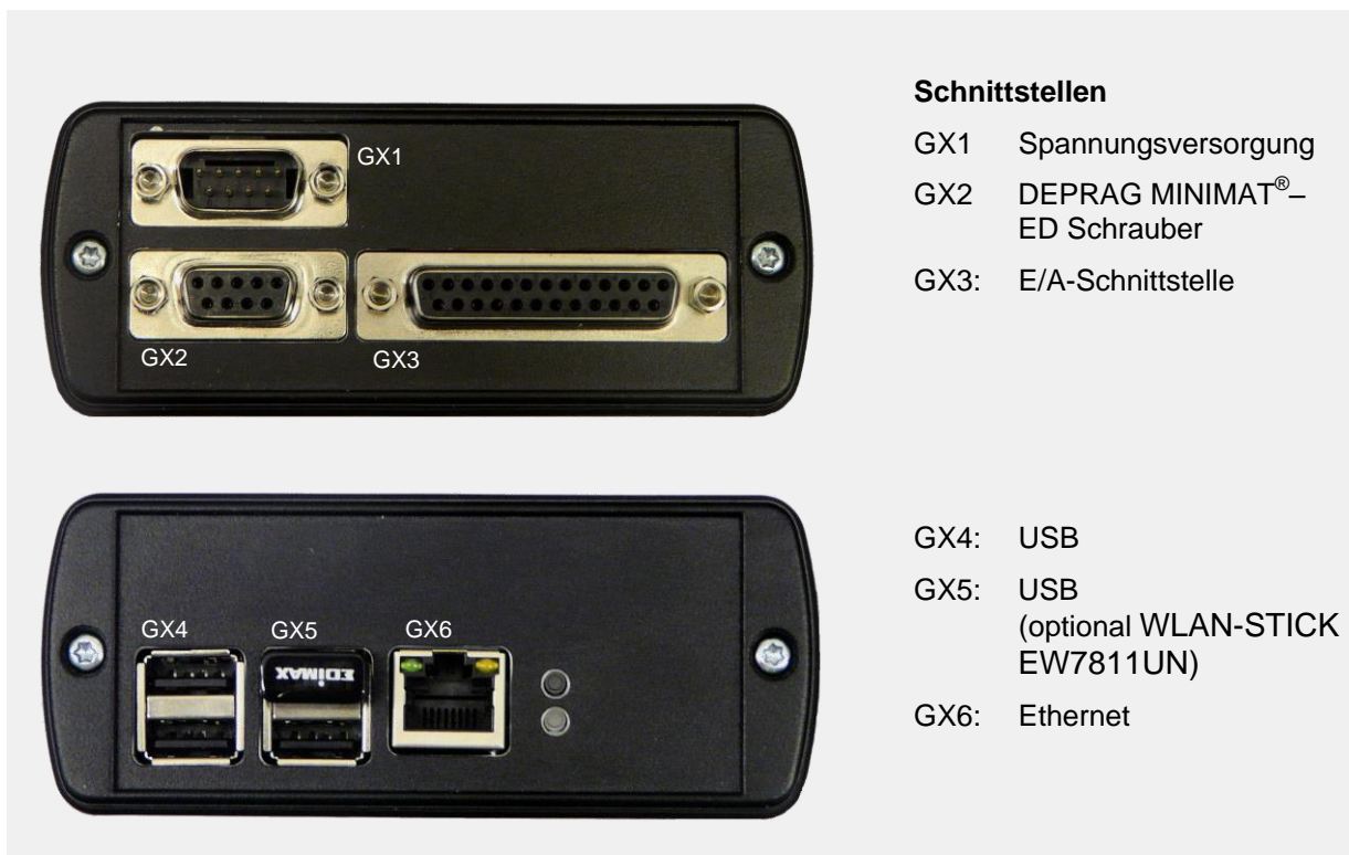
Bild 3: Anschlussseiten ComCenter ED
