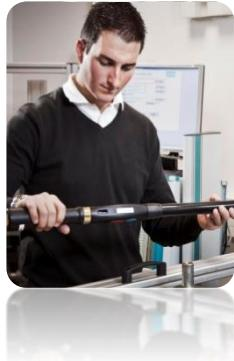
Je nach Belastung Ihres Werkzeuges nimmt die Werkzeuggenauigkeit mit steigender Einsatzdauer ab. Dies beeinträchtigt die Verschraubungsqualität und mindert die Prozesssicherheit. Eine regelmäßige Prüfung der Maschinenfähigkeit ist demnach zwingend erforderlich, um prozesssicher zu verschrauben. Eine Prüfung in kleinen Intervallen ist empfehlenswert. Sprechen Sie mit Ihrer Qualitätssicherung.
