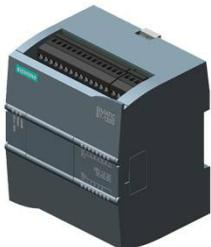
SIMATIC S7-1200, CPU 1212C, Kompakt-CPU, DC/DC/DC, onboard I/O: 8 DI DC 24V; 6 DO 24V DC; 2 AI 0-10V DC, Stromversorgung: DC 20,4-28,8V DC, Programm-/Datenspeicher 75 KB
