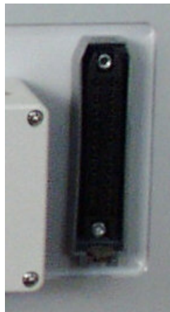
Abb. 4 : Steckverbinder zum Anschluss der Temperatur-Kontrollleitungen
