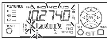
Als HH-Grenzwert wird der Mittelwert zwischen dem in Schritt 2 erfassten Wert des mangelhaften Messobjekts mit dem Fehler HIGH und dem in Schritt 3 erfassten Wert des mangelhaften Messobjekts mit dem Fehler HH festgelegt.
