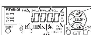
Durch Drücken der Pfeiltaste [nach oben] wird der Grenzwert erhöht.
