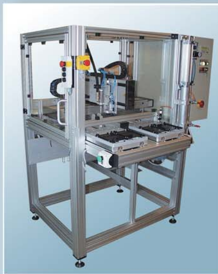
Automatische Dosierung von Silikondichtungen mit X-Y-Z- Koordinatensystem
