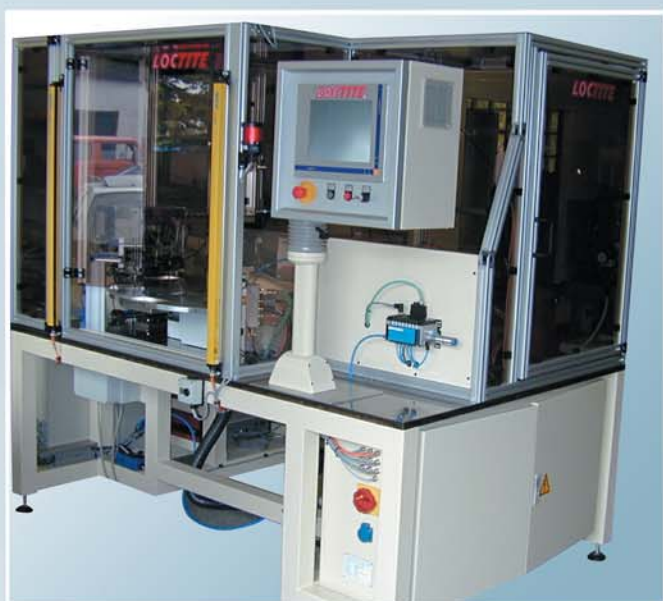
Dosier- und UV-Aushärtestation für medizinische Klebeanwendungen
