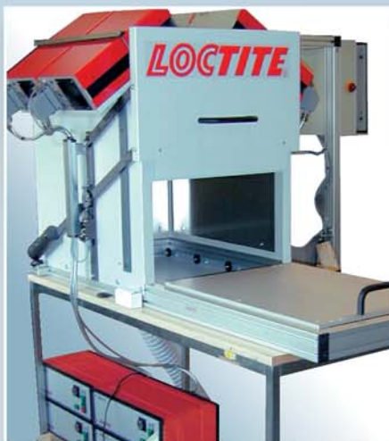
UV-Aushärtestation für Kraftwerksbauteile
