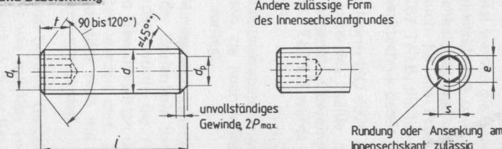
Bezeichnung eines Gewindestiftes mit Innensechskant und Gewinde  $d = M 6$ , Nennmaß  $l = 12$  mm und Festigkeitsklasse 45H:
