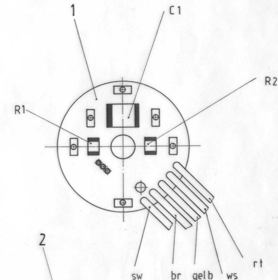
Bohrung für Welle Ø2,5h7
