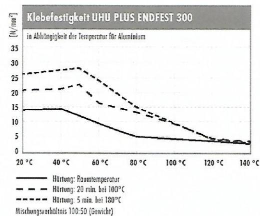
**Durchführung:** Zugscherfestigkeiten in Anlehnung an DIN 53286; vor Prüfung Lagerung 7 Tage bei 20 °C/65% relative Luftfeuchtigkeit; Zwick Prüfmaschine mit Temperierkammer (Prüfgeschwindigkeit: 50mm/min)
