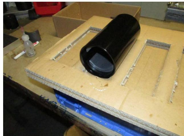
Die unteren Magnetschalen auf der rechten und linken Seite im Gehäuse mit UHU Plus kleben
