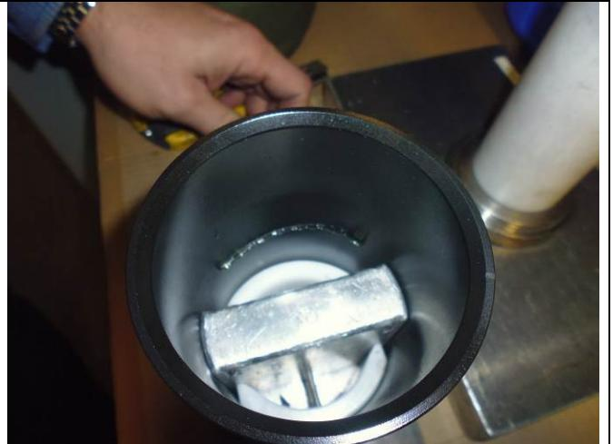
Die ersten 2 Magnetschalen rechts und links in Gehäuse einsetzen
