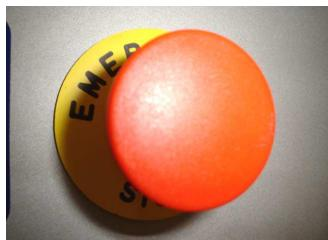
Bei Anomalien oder Gefahren kann die Maschine durch Betätigung einer der Notschalter gestoppt werden.
