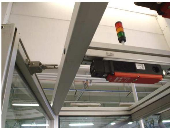
Die Zugangstüren zur Maschine verfügen über einen mechanischen Türsperrmechanismus.
